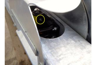
1 graisseur sur le crochet automatique d'attelage
